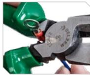
**Dispositivo prensa terminais para bitolas de até 10mm<sup>2</sup>:** duas ferramentas em uma.
