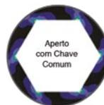
**Aperto com soquete comum:** Forças concentradas em pequenos pontos favorecem o surgimento de trincas, diminuem a vida útil dos soquetes e espanam porcas e parafusos.
